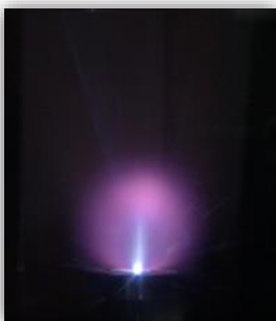
Slika 7 Oblak laserski proizvedene plazme u pozadinskom plinu
