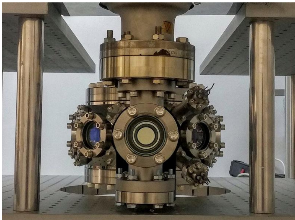
Slika 2. Komora za realizaciju druge generacije hladnih atoma na Institutu za fiziku.
