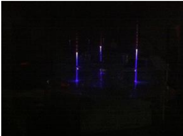
Slika 9 Niz od tri plazmena mlaza u interakciji sa površinom vode.
