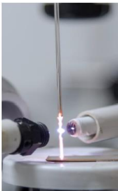
Slika 11 interakcija laserski proizvedene plazme sa atmosferskim izbojem: lijevo izvor sa cilindričnom elektrodom, desno izboj s jednom elektrodom. U sklopu suradnje u COST akciji TD1208 – STSM.35842, Enhanced plasma jet LIBS spectroscopy, Dejan Maletić, Institute of Physics, Belgrade (RS).
